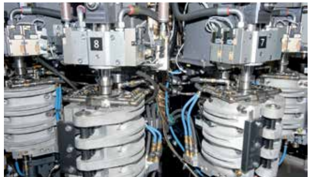
Komplette Blasformeinheit mit mehreren Vertiefungen.
